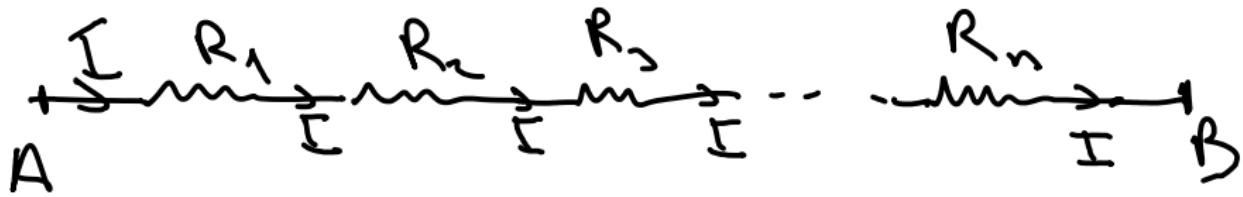
$$V_A - V_B \equiv V = V_1 + V_2 + \dots + V_n$$
