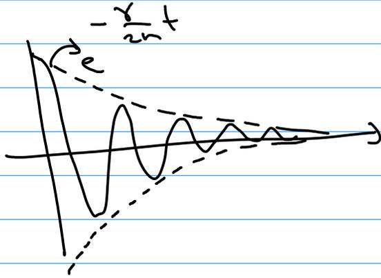
Salınıcının frekansı, beklediği üzere, sürtünme olmayan durumdaki frekanstan küçüktür.
