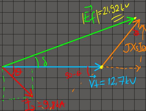
$$|jX_s I_{ph}| = 1,2 \cdot 9,8 \text{ kA} = \underline{\underline{11,8 \text{ kV}}}$$
