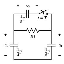
$v_1(0) = -3 V$ ,  $v_2(0) = 7 V$ ,  $v_3(0) = 3.5 V$ ;  $v_1(T^{-}) = 0$ .
