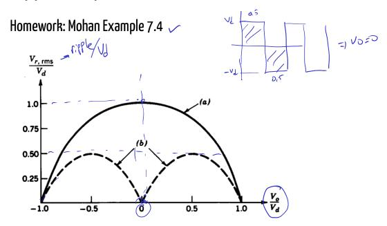
a) Bipolar PWM, b) Unipolar PWM
